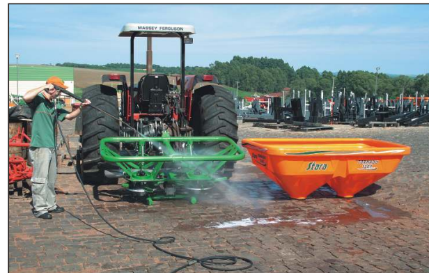
Caja removible en polietileno estructurado de alta resistencia, la cual permite la fácil limpieza y manutención.
