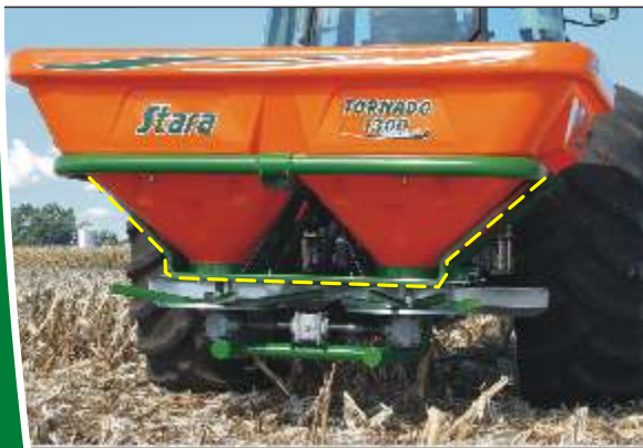
Box bottom, opening floodgates, disks, and vanes in stainless steel. Fondo de caja, compuertas de abertura, discos y paletas de acero inoxidable.
