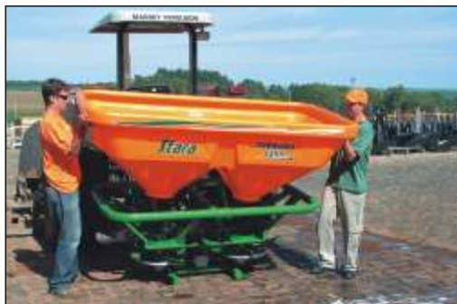
Box bottom, opening floodgates, disks, and vanes in stainless steel. Fondo de caja, compuertas de abertura, discos y paletas de acero inoxidable.
