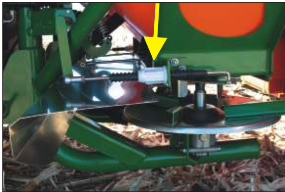
Adjustment system through scales, with hydraulic opening or cable "Pull-Push". Sistema de regulación a través de escalas con abertura hidráulica y cabos "Pull-Push".
